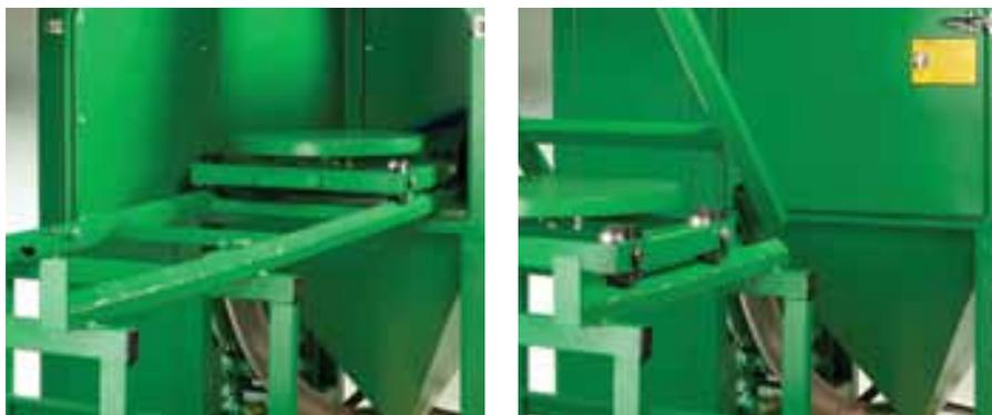
Массивная конструкция путей и тележки рассчитана на вес изделия до 350 кг.
