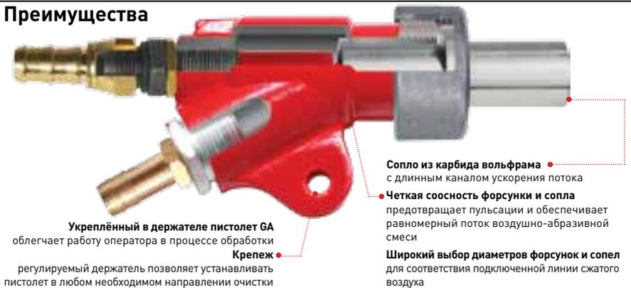
**Укрепленный в держателе пистолет GA** облегчает работу оператора в процессе обработки
