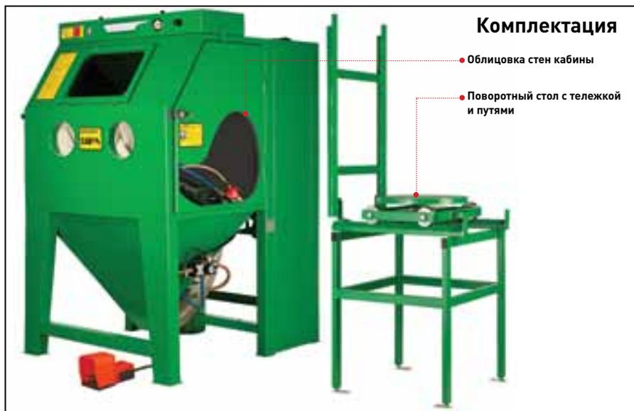
Кабины серии ST предназначены для промышленной эксплуатации при средних и больших объёмах работ. Основная задача - обработка габаритных и тяжеловесных изделий. Тяжеловесные изделия немного проще загрузить в кабину, используя поворотный стол с тележкой и путями.
