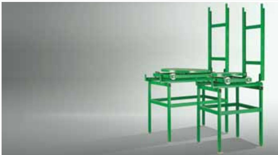
Тяжелые изделия намного проще загрузить в кабину, используя поворотный стол с тележкой и путями.
